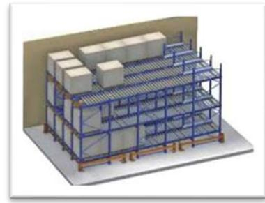
Las estanterías dinámicas para el almacenaje de unidades paletizadas son estructuras compactas que incorporan caminos de rodillos, colocados con una ligera pendiente que permite el deslizamiento de las paletas sobre ellos.
