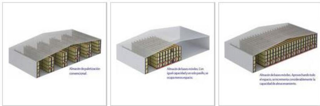
Las anteriores ilustraciones nos permiten dimensionar la capacidad de aumento de capacidad que proporciona el sistema de bases móviles (del 80 al 120% más que el sistema de paletización convencional). El incremento dependerá del tipo de carretillas que se utilicen, de las dimensiones de la instalación y del número de calles abiertas que se necesiten.
