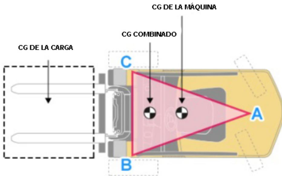
Aquí hay algunos factores que pueden afectar el triángulo de estabilidad de una grúa horquilla:
